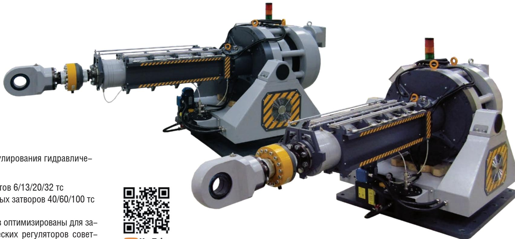
Электроцилиндры для регулирования гидравлических турбин
