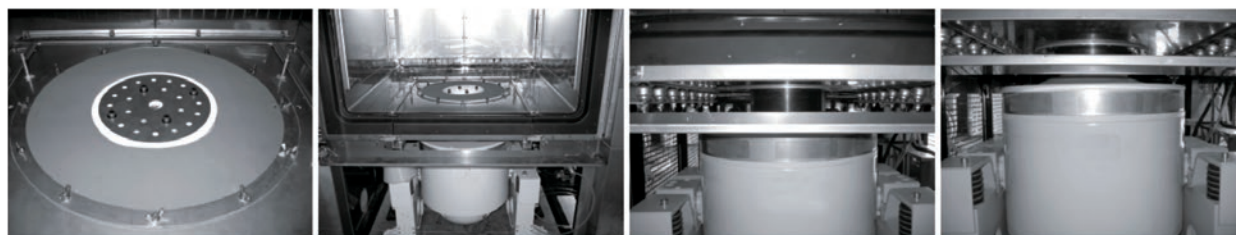
Вибростенд непосредственно подсоединяется к камере испытаний
