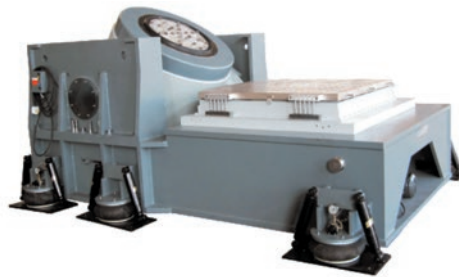
Установка на воздушные подушки
