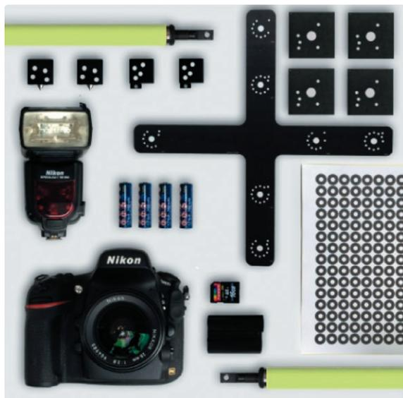
Система позволяет получать координаты опорных точек на поверхностях крупногабаритных предметов. С ее помощью возможно с высокой точностью определять размеры или анализировать отклонения геометрии от трехмерной математической модели.
