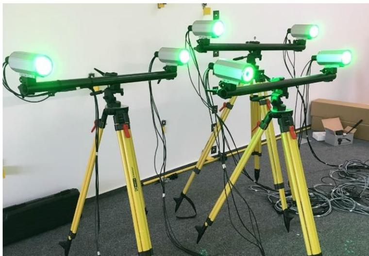
Система может включать в себя от 2 до 32 видеокамер, систему освещения, высокопроизводительную рабочую станцию, специальное программное обеспечение для обработки видеопотока, а также маркеры-отражатели, щупы, калибровочные приспособления, кабели и аксессуары, облегчающие процесс измерений.
