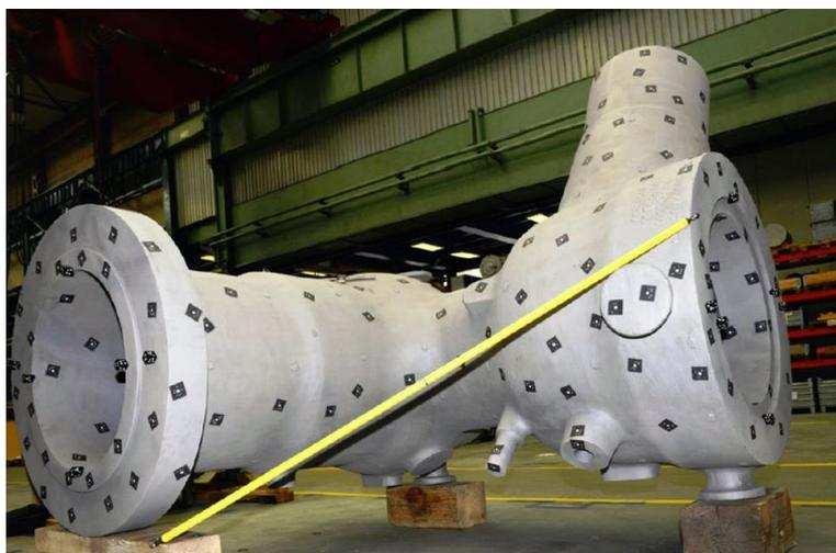
Для выполнения измерения объект обклеивается единичными отражающими маркерами – метками и специальными закодированными метками для сшивки изображений с нескольких камер
