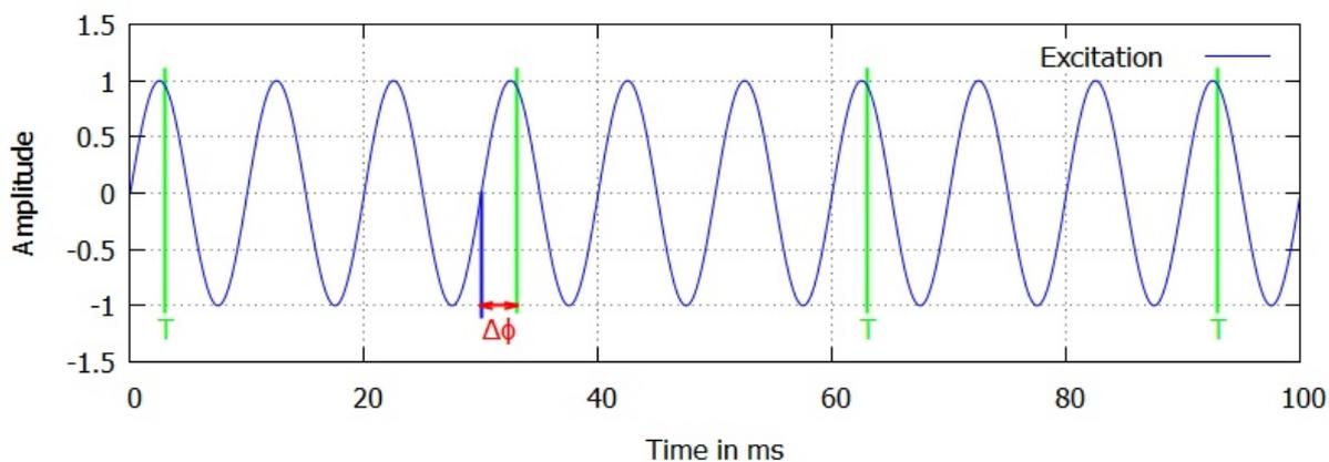
При срабатывании с постоянным отношением фазы к входному сигналу движение вибрации объектов фиксируется.
