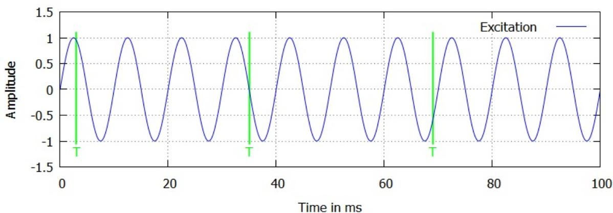
При срабатывании с изменяющейся во времени фазой (=>фазовая развертка) движение объектов отображается в замедленном режиме. Частоту развертки можно изменять.
